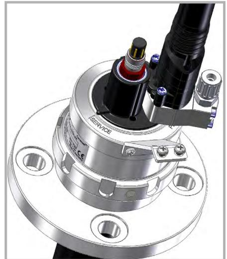
Der Adapter mit dem Multistecker kann jetzt wie dargestellt an die Wechselarmatur Ceramat WA1\*\* montiert werden.
