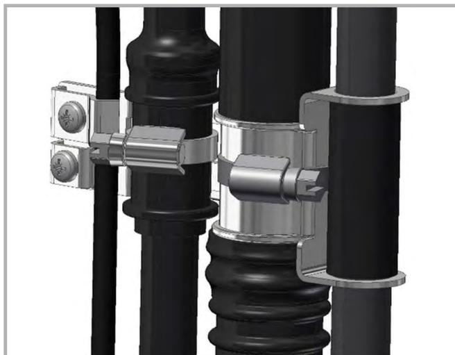
Mediendruckschlauch mittels Halteklammer und Schelle wie dargestellt montieren.
