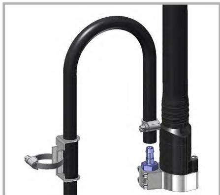
Mediendruckschlauch EPDM DN8 auf Schlauchnippel stecken und mit Schelle sichern.
