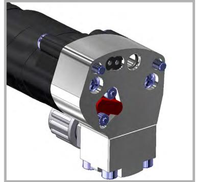
Jetzt die verlängerte Endlagenkapsel wie dargestellt in den Adapter einführen. Dabei müssen sich die 3 Kontakte der Endlagenkapsel in den Kontakten im Multistecker finden. Nach Erreichen der richtigen Lage die Endlagenkapsel weiter einschieben und mit den Schrauben fixieren. Der Adapter kann jetzt vollständig mit dem Multistecker verschraubt werden.
