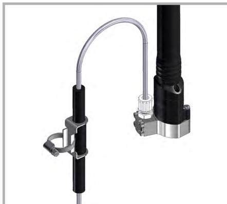
Mediendruckschlauch 8x1 (PTFE) in PFA-Verschraubung montieren.
