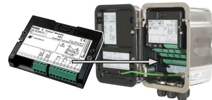
**ACHTUNG!** Eindringende Feuchtigkeit. Kabeldurchführungen müssen dicht schließen. Setzen Sie ggf. geeignete Blindstopfen oder Dichteinsätze ein.
